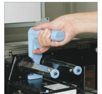
Ein vertikal anhebbarer Kopf für einfachen Zugang
