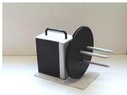
MC-11 mit einstellbarer Kernhalterung
